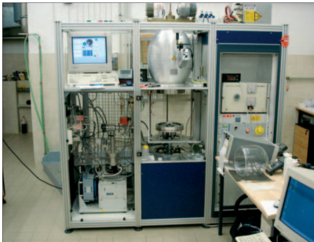
Obr. 1: Aparatura na depozici diamantových a nanodiamantových vrstev metodou rozkladu plynů v mikrovlnném plazmatu (microwave plasma enhanced chemical vapor deposition). V levé části je řídicí počítač, vakuové čerpací zařízení a plynové průtokoměry, v prostřední části vlastní eliptický mikrovlnný reaktor, v pravé části pak mikrovlnný generátor (výkon 5 kW) a pomocné zařízení pro nukleaci nanodiamantu
