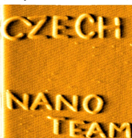
Obr. 2. Možnosti nanotechnologií vytvářet umělé nanostruktury: nápis s šířkou čáry cca 150 nm byl vytvořen lokální oxidací Ti na Fakultě strojírenské inženýrství VUT v Brně.
