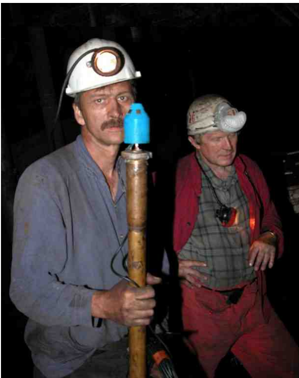
Kuželová tenzometrická sonda pro dlouhodobá měření změn napětí připravená k instalaci / Conical gauge probe for long term monitoring of stress tensor changes is prepared for installation
