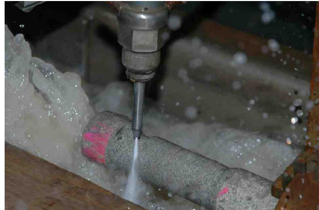
Obrábění pískovcového vzorku abrazivním vodním paprskem / Abrasive water jet machining of sandstone sample
