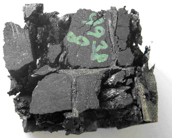
Uhlý geokompozit po zkoušce v prostém tlaku si i přes značné poškození stále udržuje soudržnost / Coal geocomposit after uniaxial test. Although geocomposit is greatly damaged, relative coherence of it is still kept.
