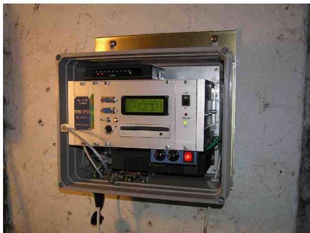
Seismická aparatura PCM3-EPC vyvinutá na oddělení / Seismic apparatus named PCM3-EPC developed at the department
