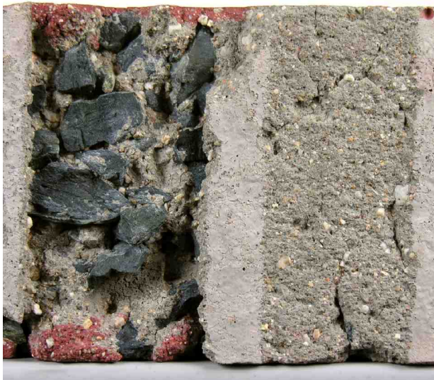
Účinky rotačního pulsujícího (vlevo) a rotačního kontinuálního (vpravo) paprsku na betonový vzorek / Effects of rotating pulsating (left) and rotating continuous (right) jets on concrete sample
