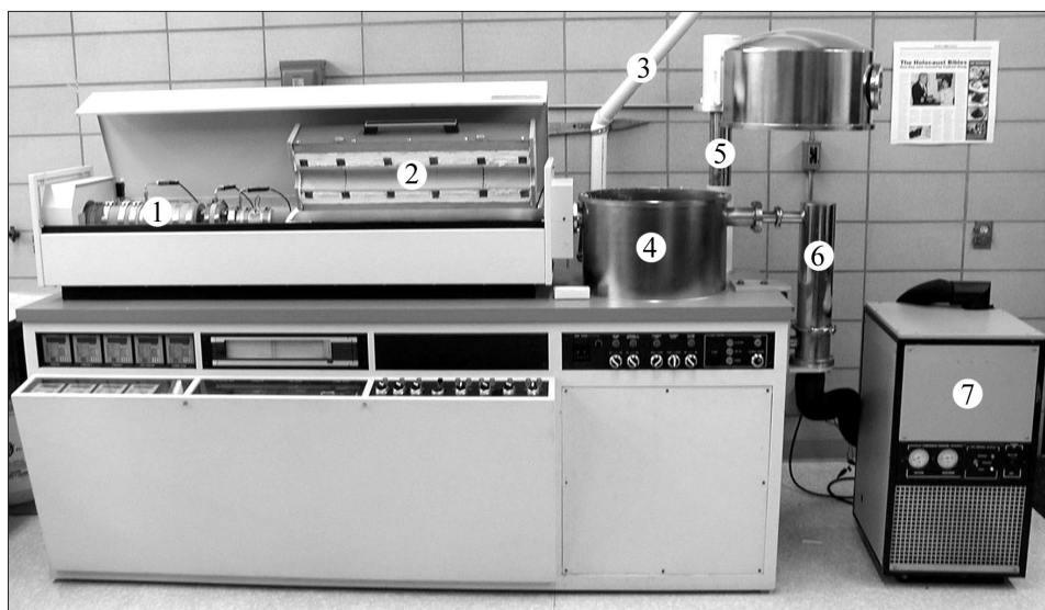
Obr. 4. Přístroj na konzervaci parylenem (NOVA TRAN, model 1050) a jeho části: 1. Odpařovací komora, 2. pyrolyzní komora, 3. výfuková trubice, 4. depoziční komora, 5. hydraulický zvedák krytu depoziční komory, 6. odlučovač, 7. kondenzační komora. — Fig. 4. NOVA TRAN Parylene Deposition System Model 1050 Coating Device and its components: 1. Vaporizer, 2. Pyrolysis Chamber, 3. Exhaust Tube, 4. Deposition Chamber, 5. Hydraulic Chamber Lift, 6. Cold Trap, 7. Condensor.
