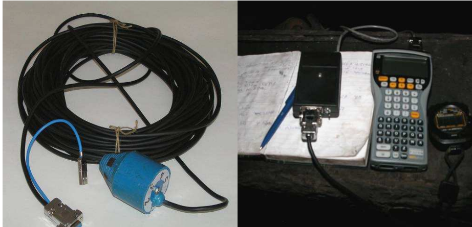
Obr. 2. Sonda pro dlouhodobá měření změn tenzoru napětí (vlevo), externí přenosné záznamové zařízení PSION (vpravo)
