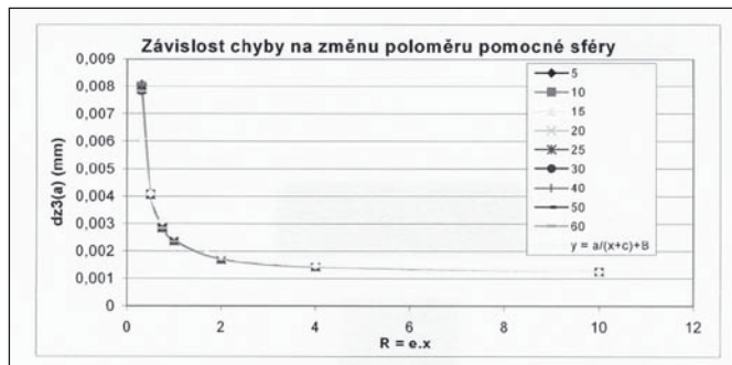
Obr. 13 Hyperbolický charakter hodnot justážních chyb v závislosti na poloměru křivosti pomocného sférického zrcadla vyjádřeném jako násobek lineární excentricity hyperboloidu e
