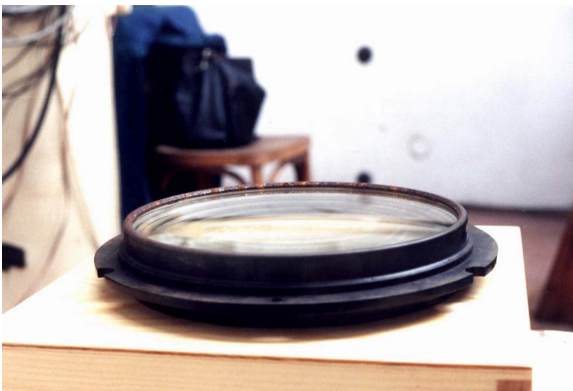
Demontáž Clarkova 8-palcového achromátu z fotosférického dalekohledu Slunečního oddělení AsÚ dne 26. dubna 1999 k jeho převozu do Vývojové optické dílny AV ČR v Turnově. Po vyčištění mu tam proměřili geometricko-optické parametry. V barvě vyniká rez objímky z kondenzací par, ta již kontaminovala skla u obvodů.
