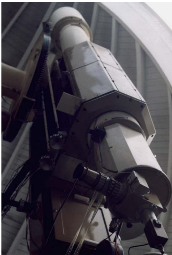
Monitorovací fotosféricko-chromosférický dalekohled Slunečního oddělení AsÚ AV v Ondřejově.
