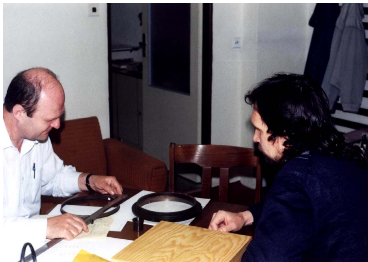
Vlastní rozebrání Clarkova objektivu v turnovské VOD předcházelo jeho pečlivé prohlédnutí jako celku, výběr pro něj šetrného rozvolnění a stanovení všech geometrických parametrů skel, i objímky.
