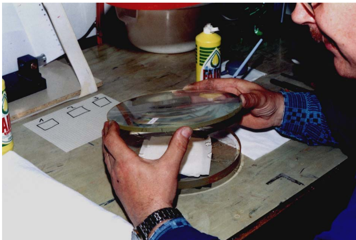
Pan Bohdan Šrajer separuje oba optické členy Clarkova dubletu. Tenká korunová spojná čočka šokuje.
