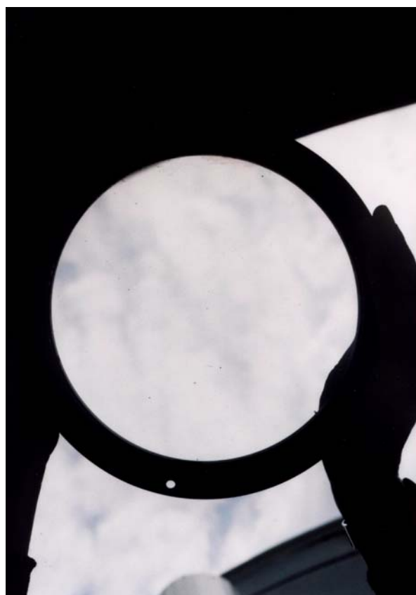
Sejmutí Clarkova osmipalcového objektivu kvůli převozu na jeho čištění a proměření geometricko-optických parametrů dne 27. dubna 1999 v turnovské Vývojové optické dílně AV ČR. Vlevo nahoře je irisová clona, tj. aktivní vstupní apertura, jejíž vymontování umožňuje postupnou demontáž objektivu.
