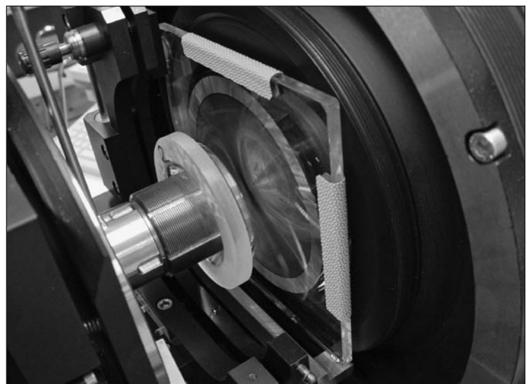
Interferometrische Messung mit CGH und 10'' - Prüfobjektiv
