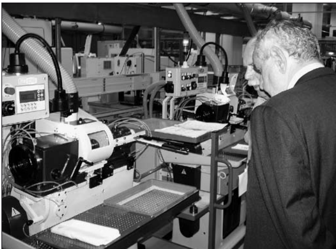
Obr. 7 Modernizovaný centrovací stroj DZ 48 v provozu v CZ Jena, s procesem seznamuje pan Jagusch (CZ Jena) pana P. Rausnitze (majitel Meopta-optika, s.r.o.)
