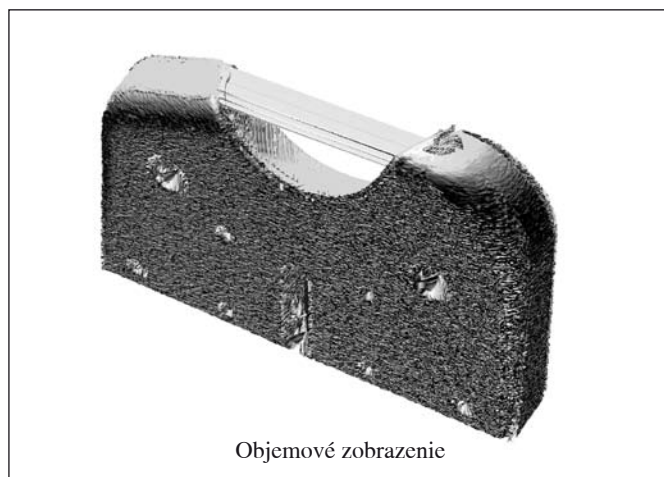
Obr. 6 Naskenovaná bočná časť navíjacej šablóny vinutia rotora elektromotora
