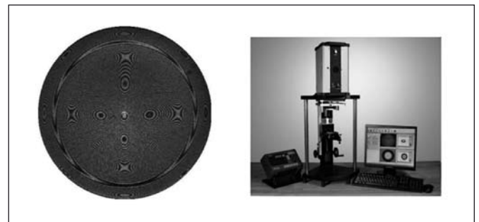
Obr. 8 Interferometr Intellium™ Asphere pro kontrolu asférických ploch (ESDI)
