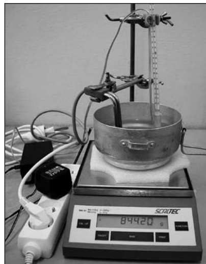
Obr. 6 Měření rychlosti vypařování: Ponorný vařič řízený jednoduchým spínacím obvodem funguje jako termostat, nádoba s vodou je pravidelně vážena
