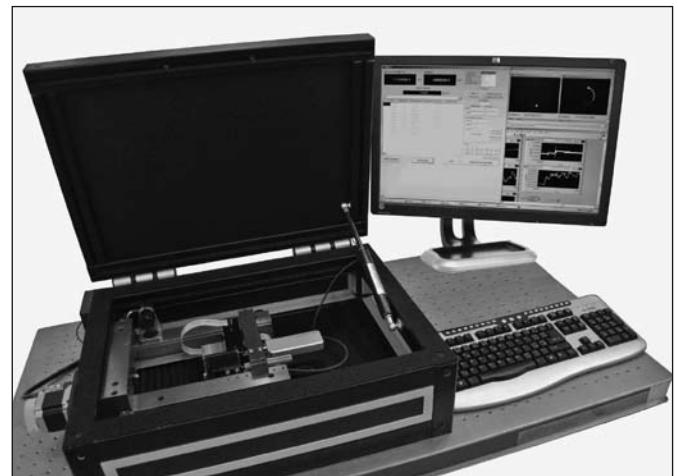
Bild 3. Resultierende Anordnung des Laserkomparators für Kalibrierung der Längentaster. Links ist das System selbst in Schutz-Abdeckbox, rechts Monitor des Steuerrechners, für die Darstellung des Messverlaufs
