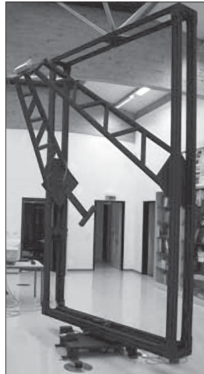
Obr. 5 Goniofotometer s obrazovým snímačom CCD firmy Techno Team Bildverarbeitung
