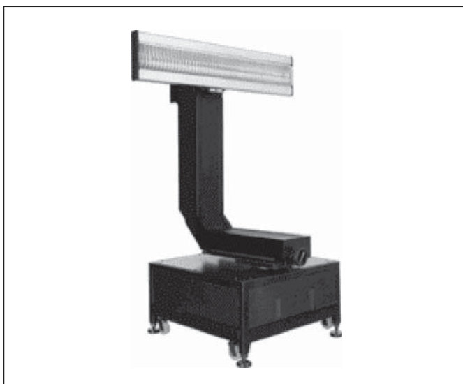
Obr. 1 Obracač zdrojov firmy LMT
