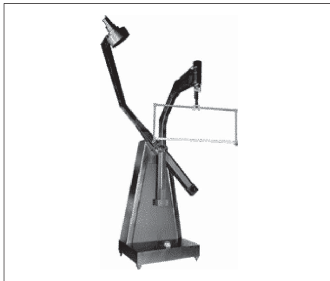
Obr. 2 Goniofotometer s otočným ramenom firmy LMT
