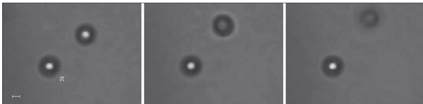
Obr. 6 Zachycení mikročástice (označena šipkou) o velikosti 2 \mu\text{m} (4K-02 Duke Scientific) v kapce filtrované vody kompaktní optickou pinzetou s laserovou diodou. Mikročástice je zachycena v objemu vzorku a v optické pasti přesouvána dále od krycího skla, obraz nezachycené mikročástice na podložním skle se rozostřuje. Pohyb zachycené mikročástice je omezen optickou pastí o dopadajícím výkonu 55 mW. Úsečka na prvním obrázku odpovídá vzdálenosti 1 \mu\text{m} .
