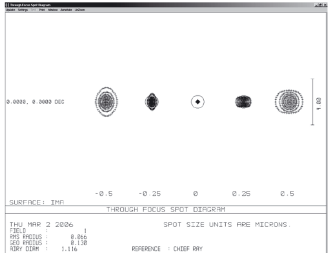
Obr. 1 Analýza tvaru stopy v okolí ohniska chytacího svazku po průchodu optimalizovanou soustavou kompaktní optické pinzety s laserovou diodou a mikroskopovým objektivem o zvětšení 100x. Byl použit program Zemax, kružnice představuje Airyho disk soustavy.
