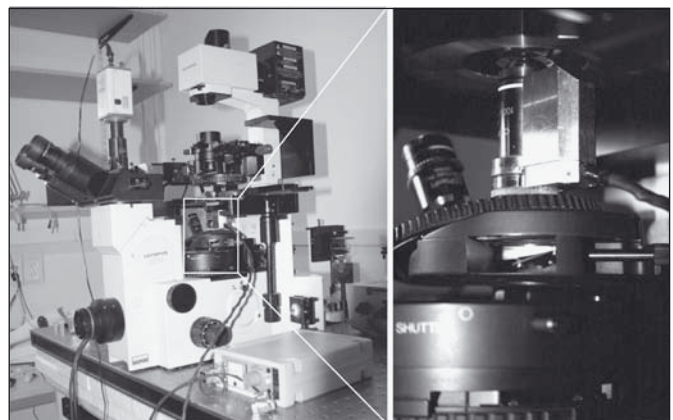
Obr. 3 Kompaktní optická pinzeta s laserovou diodou našroubovaná na invertovaný mikroskop IX 70. Vlevo celkový pohled na aparaturu, vpravo detail kompaktní optické pinzety.
