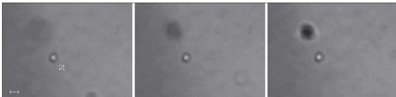
Obr. 7 Zachycení polymerové kuličky (označena šipkou) o velikosti 520 nm (3K-500 Duke Scientific) v kapce filtrované vody kompaktní optickou pinzetou s laserovou diodou. Vertikálním pohybem mikroskopového objektivu je přesouvána optická past spolu se zachyceným objektem (zůstává stejně ostrý) a současně se zaostřuje obraz objektu na krycím skle. Dopadající výkon byl 55 mW. Úsečka na prvním obrázku odpovídá vzdálenosti 1 \mu\text{m} .
