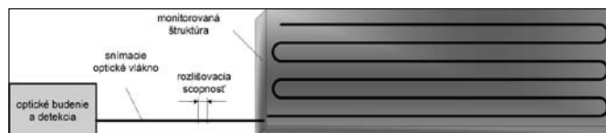
Obr. 1 Distribuovaný optický vláknový senzor zabudovaný v monitorovanej štruktúre umožňuje snímať dvojrozmerný obraz meranej veličiny
