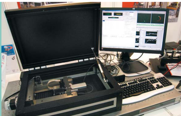
Laserový nanokomparátor pro velmi přesné kalibrace délkových měřidel, představený na 50. mezinárodním strojírenském veletrhu 2008 v Brně. Výsledek spolupráce s Českým metrologickým institutem a firmou Mesing, s.r.o. Laserový nanokomparátor je řešen jako automatický odměřovací systém o rozlišení v řádu desetin nanometrů (foto: archiv ÚFP)
