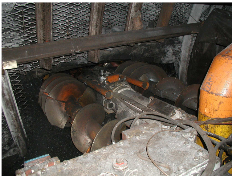
Obr.2. Odvrtnání komory č. 3 vrtacím strojem VS-Seal 625P2 Fig. 2. Drilling of room No. 3 with the drilling machine
