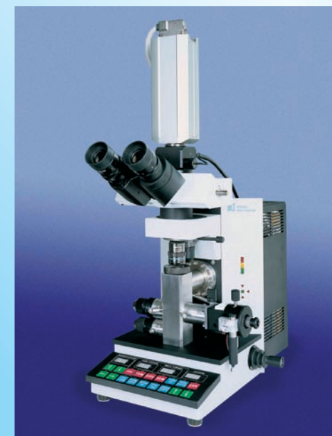
Obr. 1 Nízkovoltový elektronový mikroskop LVEM5. Vpravo od tubusu se nachází motorizovaný manipulátor objektu, vlevo pak manipulátory na kondenzorovou a objektivovou clonu. Pro pozorování obrazu na stínítku slouží optický mikroskop spojený se CCD kamerou
