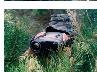
K zabezpečení průzkumu a pozorování na stupni četa / rota je určena i chlazená termovizní kamera MATIS HH. Pro akvizici cílů ji je možno kombinovat s dálkoměry řady Vector. Dosah této kamery je až 10 km.
