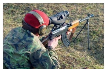
Velitelé střeleckých týmů jsou vybaveni nechlazeným termovizním zaměřovačem LTWS. Mohou tak detektovat nebezpečí a cíle dřív než vojáci s noktovizory. Ve spojení se zbraňovou akviziční jednotkou (LRF / DMC) mohou řídit palbu do 1 000 m.
