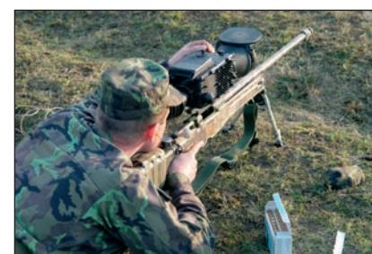
Pro podporu průzkumu a zaměřování podpůrných zbraní čety je v rámci konceptu xPAN na této úrovni k dispozici i souprava chlazeného termovizního zaměřovače M-HTWS. Účinný dosah tohoto systému je až 6 000 m (cíl typu vozidlo).
