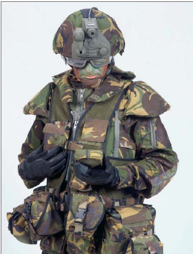
Obr. 6 Voják s základem integrovaného kompletu FELIN V1 (1 – modul osobního datového terminálu, 2 – modul inteligentního nabíječe, 3 – modul osobní rádiové stanice, 4 – modul ovladače MMI, 5 - integrovaná přílba s displejem a noktovizorem)
