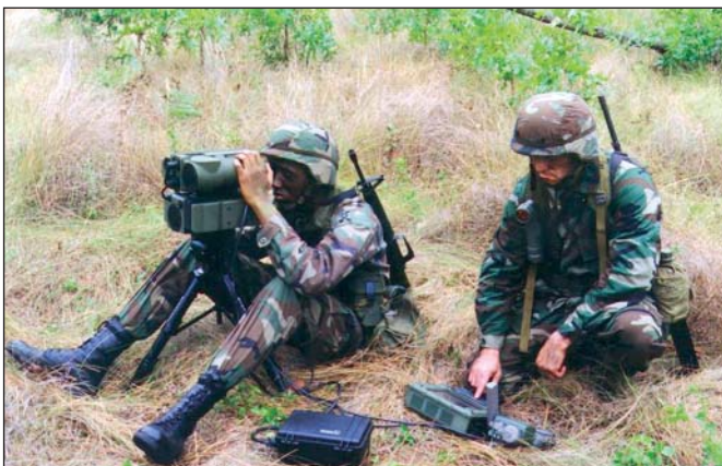
Obr. 5 Akviziční souprava LLDR pro lokalizaci cílů a navádění laserem řízené munice, na trojnožce je umístěn laserový ozařovač LDM a nad ním akviziční jednotka TLM, dále je použit externí datový terminál Tacter a přijímač GPS PLGR
