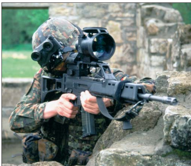
Obr. 7 Voják vybavený systémem IdZ s brýlemi nočního vidění Lucie a noktovizním zaměřovačem NSA 80
