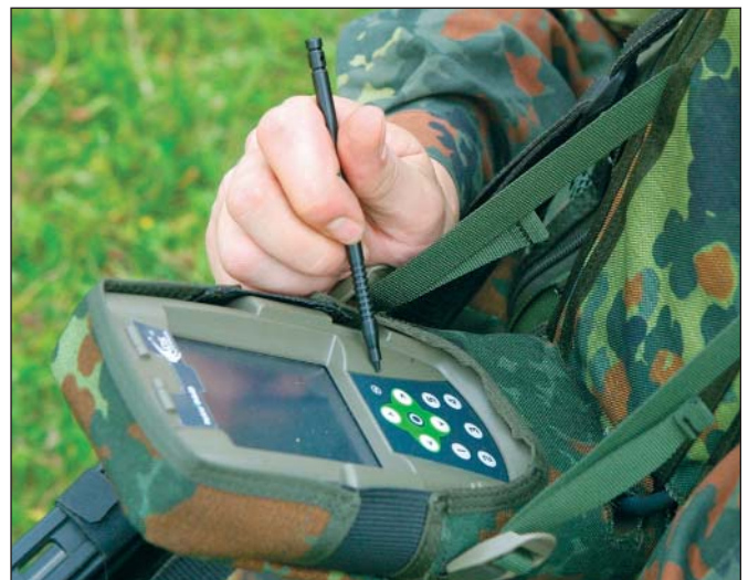
Obr. 6 Osobní datový terminál NaviPad je opatřen dotykovým displejem a je možno jej ovládat pomocí pera
