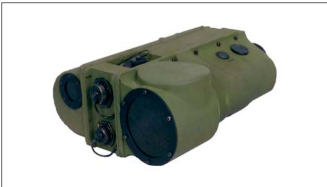
Obr. 6 Akviziční jednotka TLM kompletu LLDR, v jednom kompaktním těle je laserový dálkoměr, digitální kompas, termovizní kamera, denní CCD kamera a přijímač GPS
