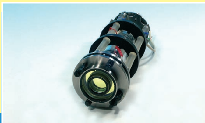
Obr. 2 Experimentální sestava stabilizace DFB polovodičového laseru s acetylenovou kyvetou
