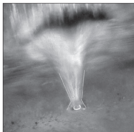
Obr. 5 Rozšíření „výstupní“ strany otvoru (sklo tloušťky 0,9 mm)
