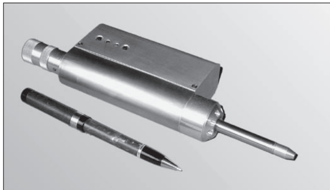
Obr. 1 Kryochirurgický přístroj pro jemné operace – snímek prototypu
