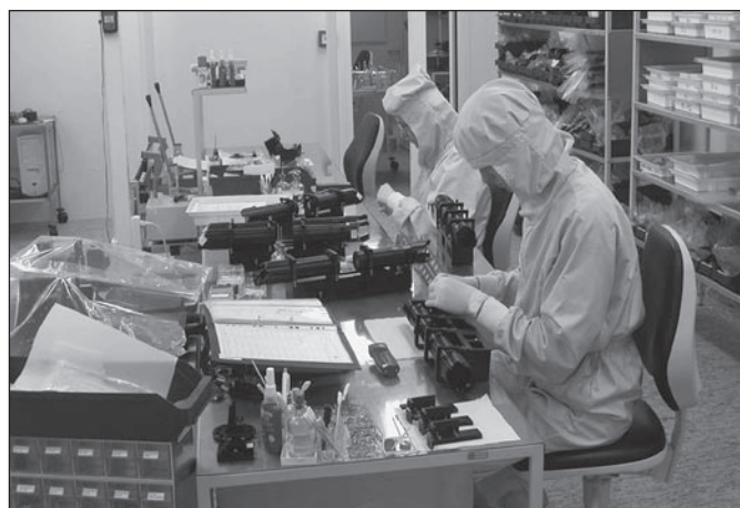
Pracoviště přesné opticko-mechanické montáže v superčistých prostorách
