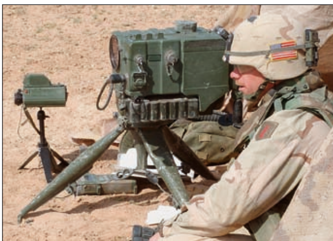
Obr. 5 Přesunutý letecký navodčích s ručním laserovým dálkoměrem AN/PVS-6 MELIOS, laserovým ozařovačem AN/TVQ-2G/VLLD a ručním přijímačem navigačního software GPS AN/PSN-11 PLGR
