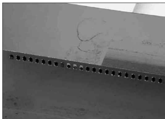
Obr. 7 Prasklina na difraktujúcom povrchu vyvolaná pnutím rastu kryštálu
