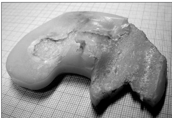
Obr. 2 Pohled na extrahovanou PE vložku TEP kolenního kloubu s různými typy opotřebení artikulárního povrchu, včetně fraktury
