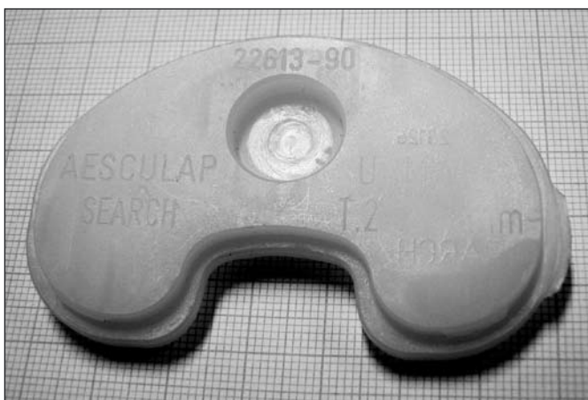
Obr. 3 Foto neartikulárního povrchu PE vložky, kterým je komponenta přiložena ke kovové tibiální komponentě
