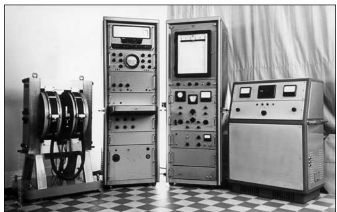
Obr. 3 Prototyp spektrometru jaderné magnetické rezonance pracující na frekvenci 30 MHz (rok 1965)
