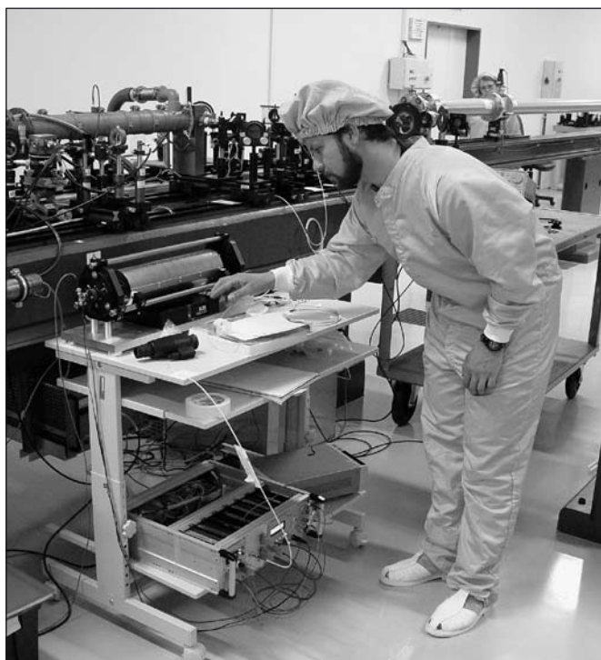
Obr. 2 Stabilizovaný laserový systém – vláknový „front end“ pro buzení pulzního laseru na pracovišti PALS
