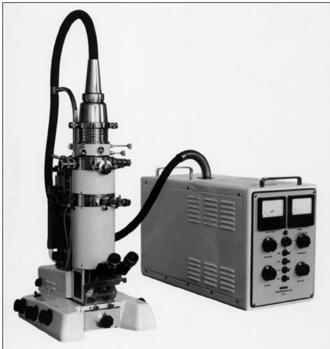
Obr. 1 Stolní prozařovací elektronový mikroskop, vyráběný po dobu cca 20 let pod označením Tesla BS 242, který byl oceněn zlatou medailí EXPO 58
