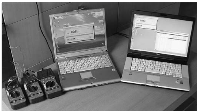
Obr. 2 Pracoviště měření závislosti vnitřní a vnější teploty na čase transpondéru MOBY I – MDS 439E
