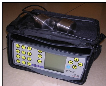
Obr 2: Přenosná ultrazvuková měřicí aparatura PUNDIT plus firmy Mastrad z Velké Británie
