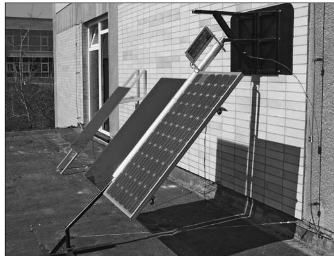
Obr. 3 Solární PV systém přímo spojený se sítí testovaný na České zemědělské univerzitě v Praze
