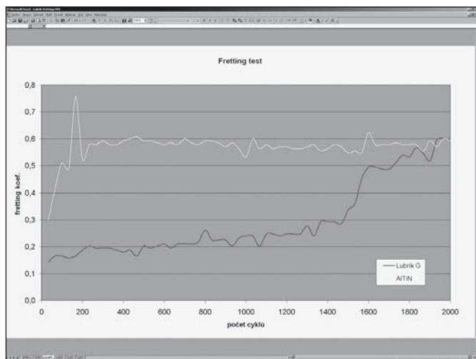
Obr. 36, 37 Průběh koeficientu frikce a detail fáze zabíhání nástroje
