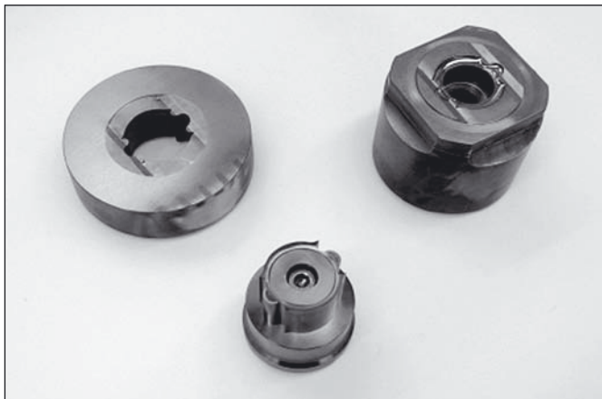
Obr. 31 tvářecí a prostřihávací nástroje
