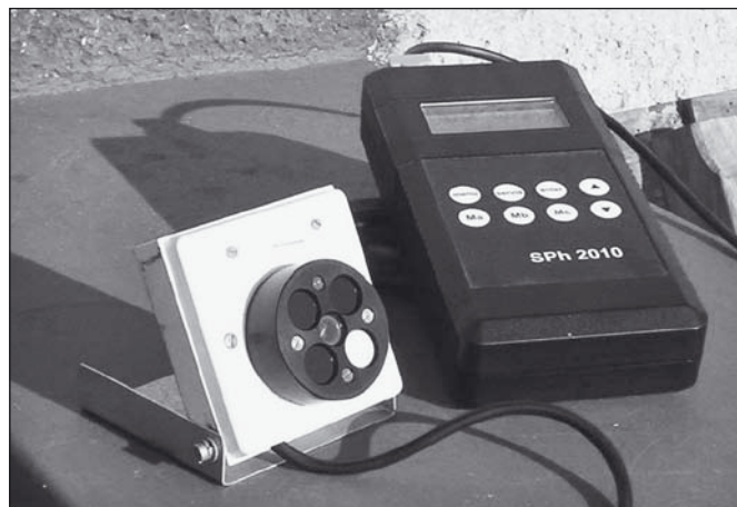
Obr. 4 Spektrální radiometr SPh 2010 se sondou SPp 200 pro měření UVB, UVA, VIS a NIR
