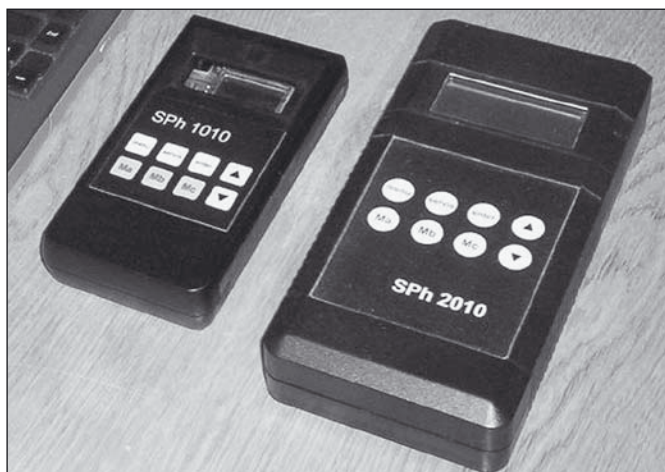
Obr. 5 Spektrální radiometry SPh 1010 a 2010 - měřicí jednotky
