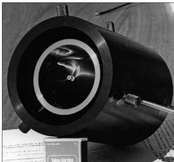
Jeden z našich prvních rentgenových objektivů tečného dopadu pro pozorování Slunce typu Wolter 1. Apertura 50mm, rok 1970
