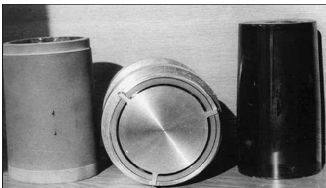
Mandrel a replikovaný objektiv o apertuře 80 mm pro kosmickou sondu Fobos 1. Kombinovaná technologie galvanoplastika a epoxy/uhlíkové vlákno
