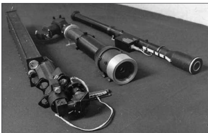
Rentgenový dalekohled a koronograf TEREK pro kosmickou sondu Fobos 1.
