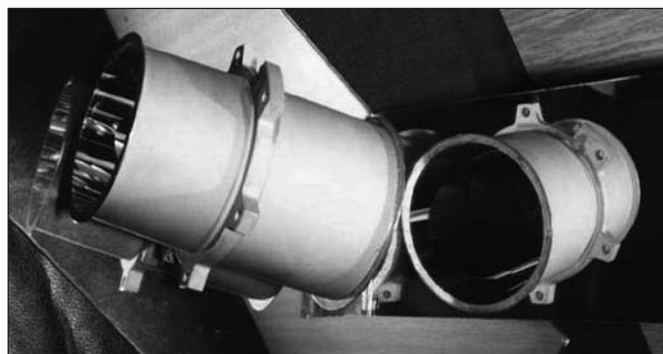
Rentgenové objektivy Wolter 1 pro družici KORONAS I, rok 1989. Poslední rentgenová optika u nás vyrobená pro program INTERKOSMOS
