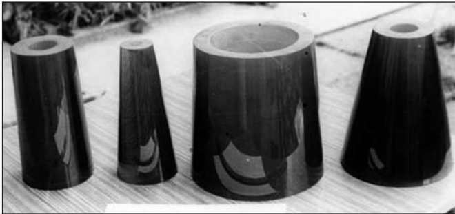
Mandrely ze skleněné keramiky pro výrobu replikační technologií složeného rentgenového objektivu o apertuře 240 mm pro rentgenový dalekohled RT-4M pro kosmickou orbitální stanici Saljut 7 (1981)
