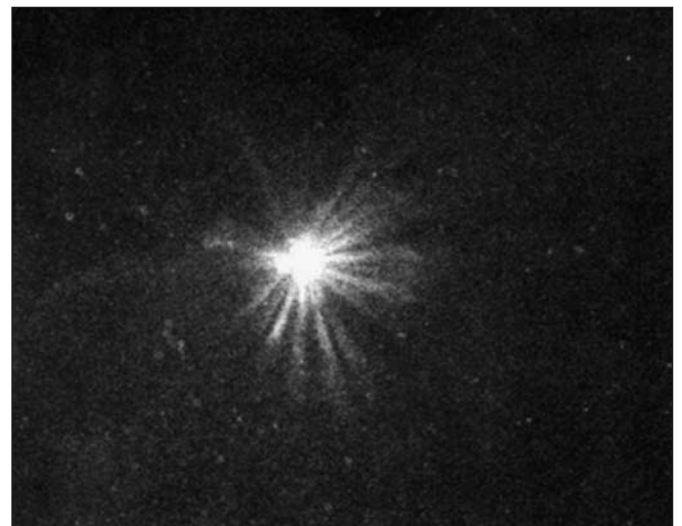
Rentgenový snímek horké laserové plazmy pořízený rentgenovým mikroskopem elipsa-hyperbola v IFPLM Varšava, Polsko
