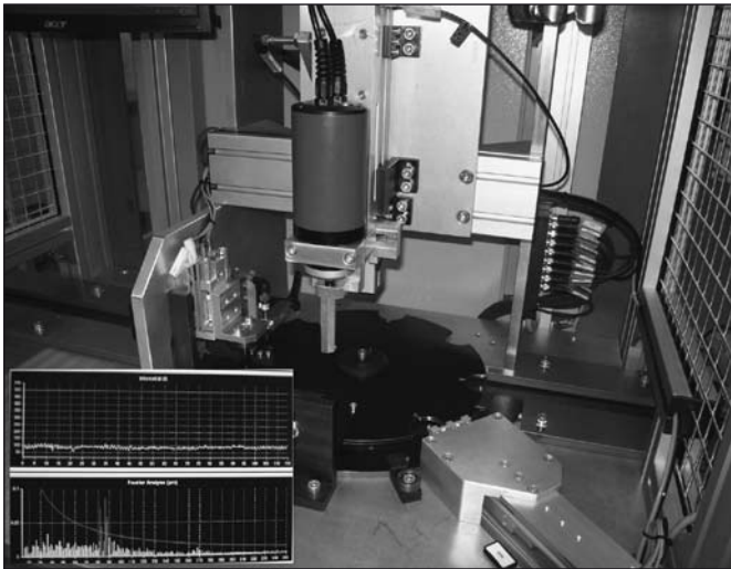
Obr. 3 Automatické měření úchylek kruhovosti
