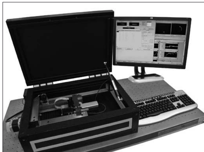
Obr. 2 Interferometrický komparátor pro kalibraci snímačů
