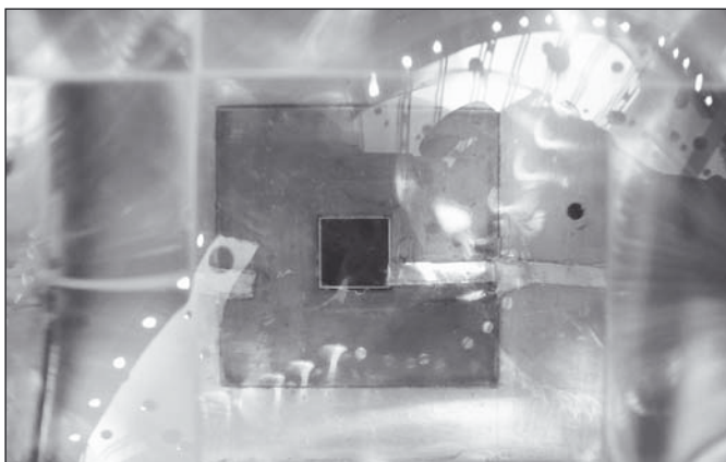
Obr. 13 Pohled na PV článek pro vysokou koncentraci záření přes Fresnelovu čočku
