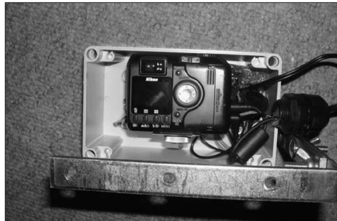
Obr. 3 Fotoaparát umístěný v krabici, upevněn je pomocí stativového šroubu
