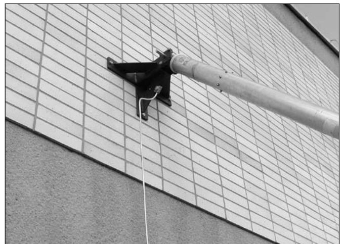
Obr. 2 Uchycení horního konce pohyblivého stojanu
