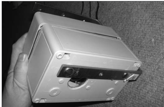
Obr. 1 Ukázka plastové krabice, ve které je umístěn fotoaparát. Dobře je vidět otvor, ve kterém bude umístěn polarizační filtr
