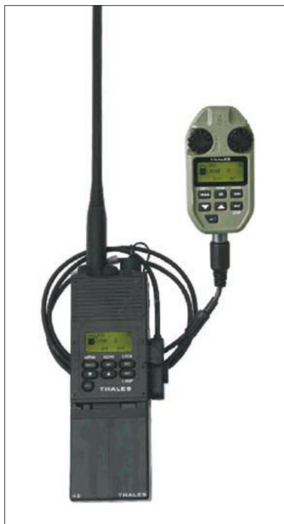
Obr. 4 – ruční rádiová stanice AN/PRC-148(V)4(C) JEM (JTRS Enhanced MBITR) s externím ovládním RCU, ve kterém je vestavěn přijímač signálu GPS
