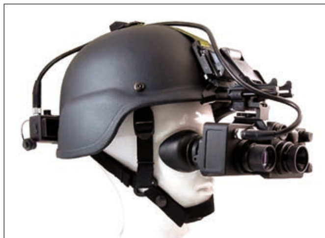
Obr. 1 DSQ - 20M - falešná fúze obrazů oblastí LWIR / VIS
