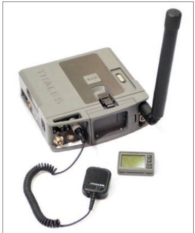
Obr. 5 – Přenosný zesilovač EBMP s vloženou stanicí AN/PRC-148 MBITR/JEM, k zesilovači je připojen externí mikrofon / reproduktor a ze zesilovače je sejmuta jednotka dálkového ovládní s bezdrátovým propojením
