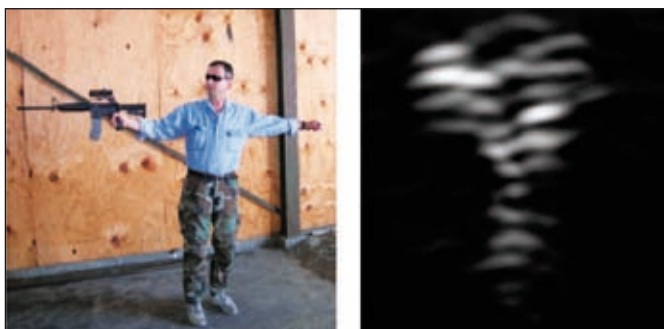
Obr. 6 Zobrazení systémem ImpSAR skrz armovanou betonovou stěnu
