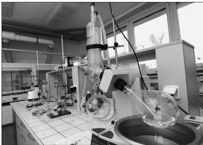
Obr. 3 Vakuová odparka umožňuje proměřit tlakovou závislost teploty varu a provádět přípravu sloučenin vyžadující destilaci za sníženého tlaku. Tyto úlohy jsou součástí bakalářského kurzu chemie.
