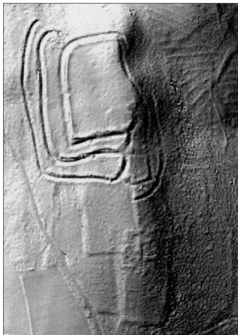
Obr. 4. Valy a příkopy hradiště Welshbury Hill: výškopisný model terénu, který byl ze středu snímku na obr. 3 dosažen použitím algoritmu odstraňujícího vegetační pokryv terénu (podle Devereux et al. 2005 ).
