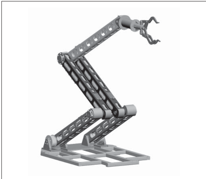
Obr. 3 Schéma manipulační nástavby bez pohonů
