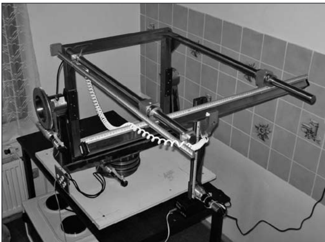
Obr. 6 Souřadnicový systém X, Y a Z pro popis polohy detektoru. Pohyby v souřadnicích X a Y nejsou motorické, vedení jsou v potřebné poloze držena svěrnými spojeními. K odměřování souřadnic jsou použita běžná ocelová měřítka
