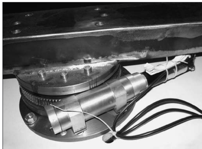
Obr. 4 Detail šnekového převodu 1:120, m = 1,6 pro pohon azimutální osy altazimutální montáže
