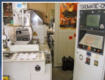
Výroba torických brýlových čoček na lince LOH
