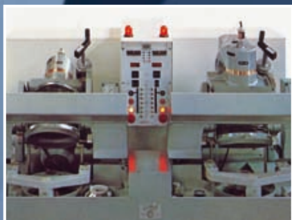
Výroba sférických brýlových čoček na lince COMES
