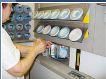
Magnetické napařování antireflexních, zrcadlových a hydrofobních vrstev na zařízení BOC
