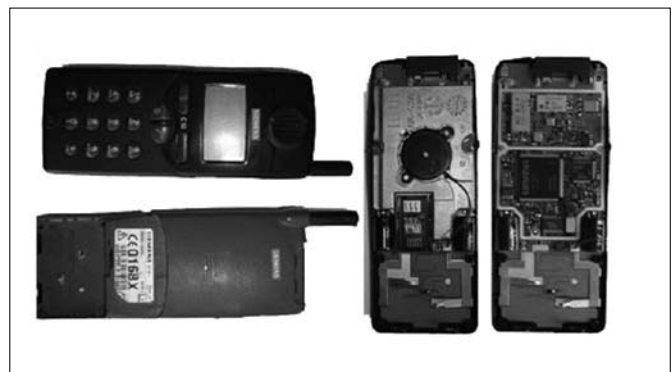
Obr. 1 Mobilní telefon SIEMENS C10, jeho elektronika s odkrytým vysokofrekvenčním modulem
