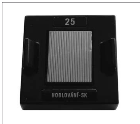
Obr. 4 Fotografický obrázek obrobeneho povrchu hoblovaním V9
