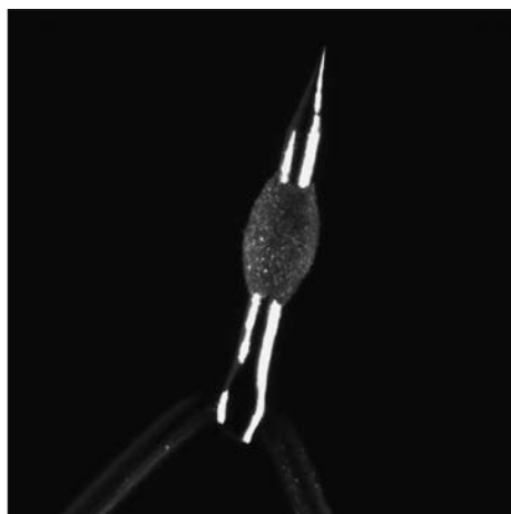
Obr. 1a Schottkyho katoda. Zorné pole 1,25 mm
