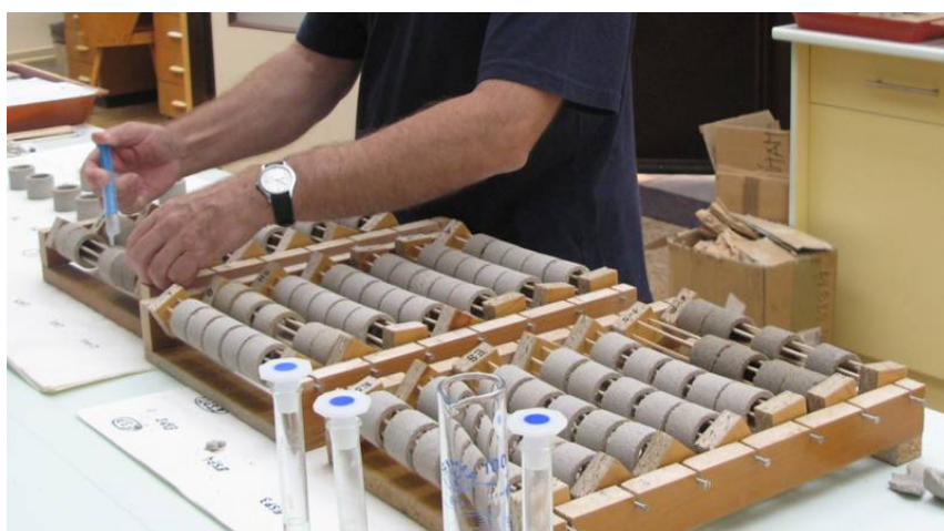
Laboratorní studie zaměřená na posouzení účinnosti vápenné vody jako potenciálního zpevňujícího prostředku historické vápenné omítky.
