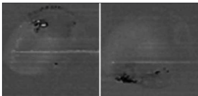
Obr. 11 Obrázky pořízené technikou MFM. Nanočástice jsou ve tkáni znázorněny jako tmavé oblasti [46]
