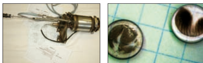
Obr. 15 Katmodul se zabudovanými chlazenými pouzdry pro endoskop a světlovod. Znečištění safírových sklíček ze dna ochranného pouzdra po měření: levé sklíčko je z pouzdra pro osvětlení, pravé pro endoskop
