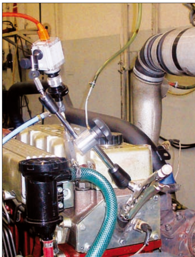
Obr. 8 Pohled na zástavbu chlazeného endoskopu s barevnou CCD kamerou pro sledování dějů uvnitř spalovacího prostoru
