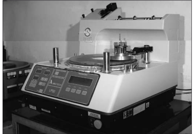
Leštění laserových tyčí
