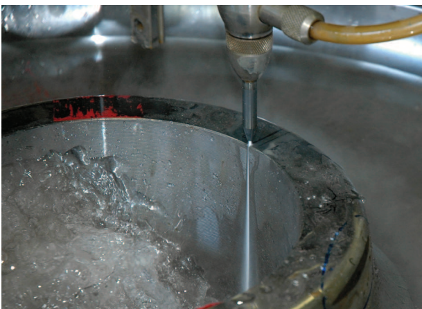
Řezání vnitřní části železničního kola abrazivním vodním paprskem / Cutting of the inner part of railway wheel by abrasive water jet
