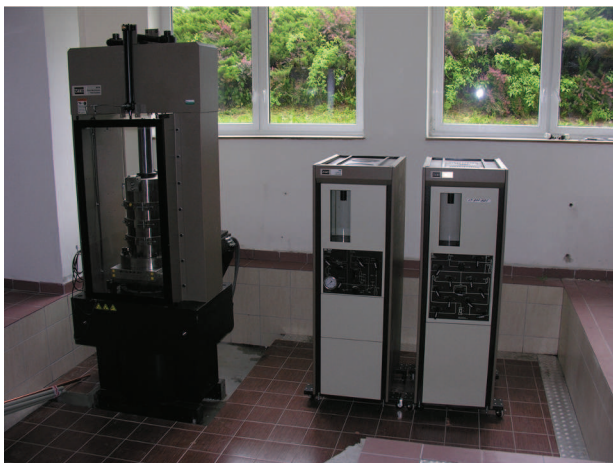
Zkušební lis s triaxiální komorou pro zkoušky hornin / Servo-hydraulic testing system and triaxial cell for testing of rocks
