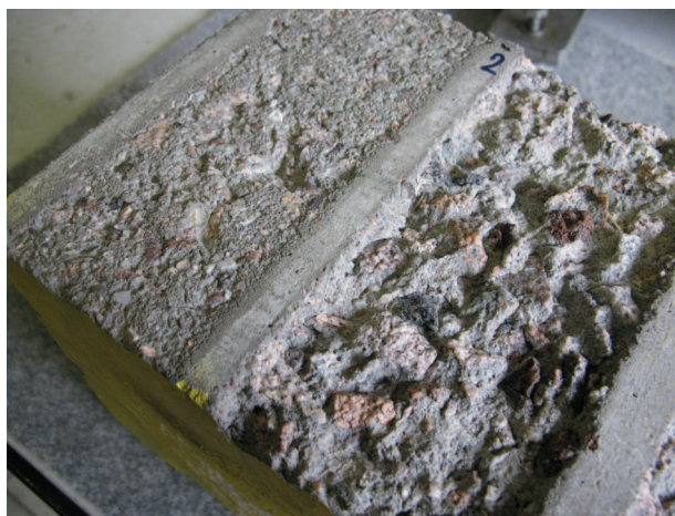
Ukázka ploch vytvořených třemi průchody plochého kontinuálního (vlevo) a plochého pulzujícího paprsku (vpravo) vedle sebe na vzorku betonu (tlak vody 30 MPa, ekvivalentní průměr trysky 2.05 mm, vzdálenost vzorku od trysky 40 mm, rychlost řezání 0.2 m.min -1 ) / Example of surfaces created by three passes side by side of both flat continuous (left) and flat pulsating (right) jets on concrete sample (water pressure 30 MPa, equivalent nozzle diameter 2.05 mm, stand off distance 40 mm, cutting speed 0.2 m.min -1 )
