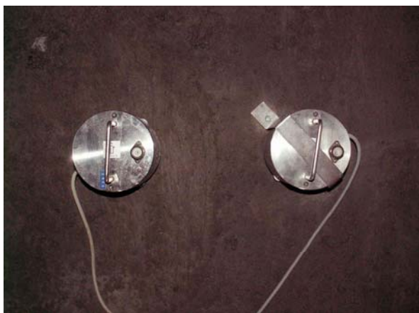
Obr. 4: Usazení senzorů ViGeo2
