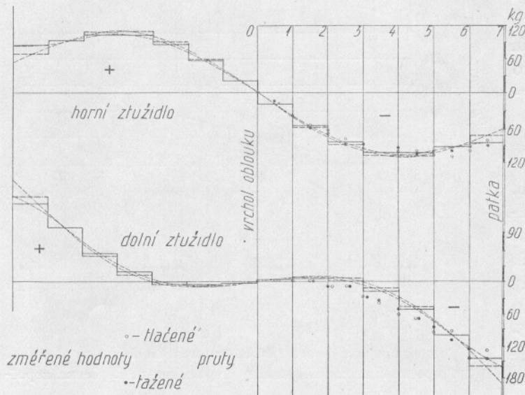
96. Teoretické a naměřené síly větrových ztužidel oblouku. 96. Теоретические и замеренные силы ветровых связей арки. 96. Theoretical and measured forces of arch wind bracings.
