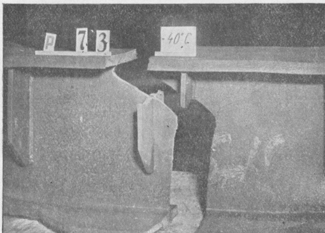
104. Zlomené zkušební nosníky. 104. Разломленные испытательные балки. 104. Fractured test beams.
