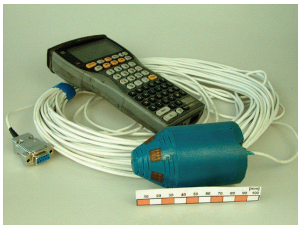
Vzhled kuželové sondy typu CCBM s přenosným datalogerem / The appearance of conical probes CCBM with portable data logger
