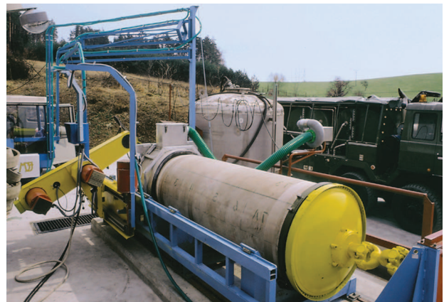
Aplikace vysokorychlostního vodního paprsku při likvidaci paliva balistické rakety krátkého doletu SS-23 / Application of high-speed water jet for dismantling of grain of ballistic short-range missile SS-23
