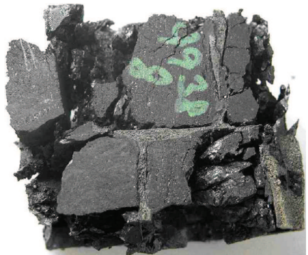
Uhelný geokompozit po zkoušce v prostém tlaku si i přes značné poškození stále udržuje soudržnost / Coal geocomposit after uniaxial test. Although geocomposit is greatly damaged, relative coherence of it is still kept
