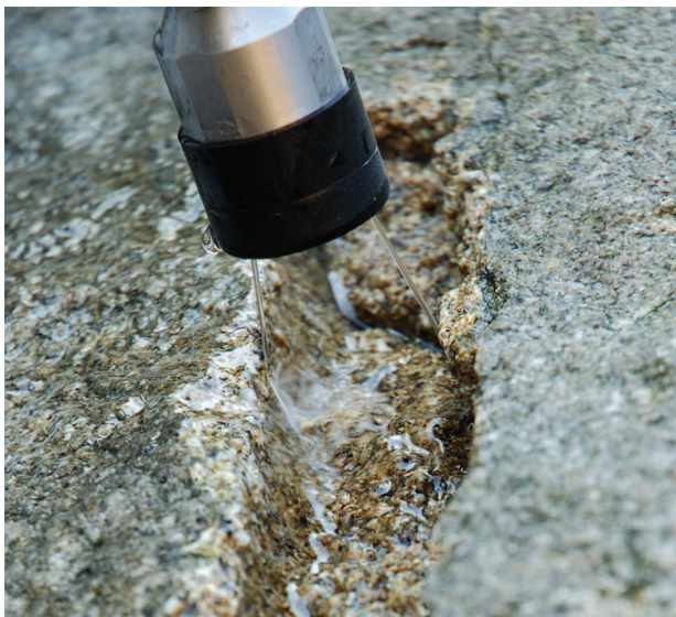
Aplikace rotačního pulzujícího vodního paprsku při dobývání okrasného kamene - detail drážky řezané v granodioritovém masivu / Application of rotating pulsating water jet in ornamental stone quarrying - detail of kerf cut in granodiorite massive
