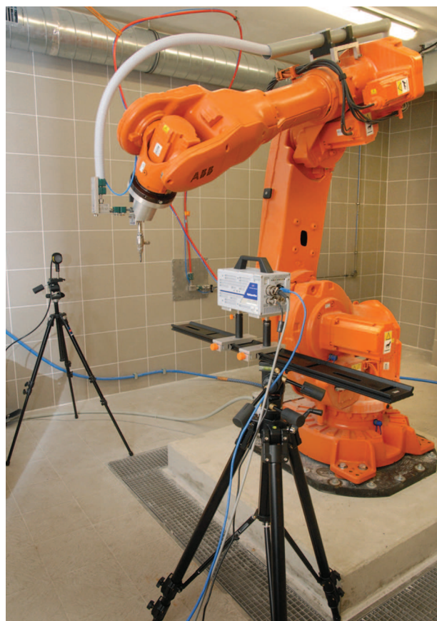
Robotické zařízení pro vývoj aplikací vysokotlakého vodního paprsku / Robot device for development of high pressure water jet applications
