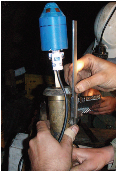
Kuželová tenzometrická sonda pro dlouhodobá měření změn napětí připravená k instalaci / Conical gauge probe for the long-term monitoring of stress changes ready for installation
