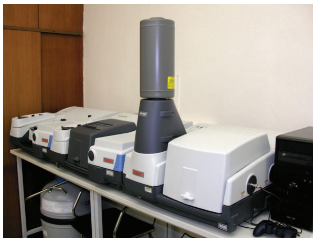
FT-IR spektrometr NICOLET 6700 s FT-Ramanovým modulem NICOLET NXR / FT-IR spectrometer NICOLET 6700 with FT-Raman module NICOLET NXR
