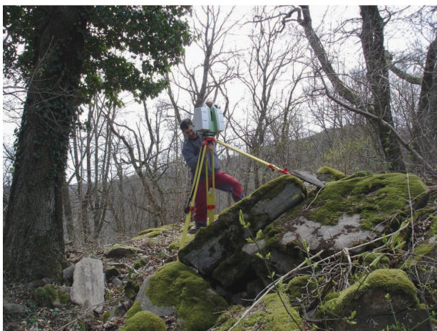
Pozemní laser skener na lokalitě Ledové sluje v Národním parku Podyjí / Terrestrial laser scanner in locality Ledové sluje in National Park Podyjí
