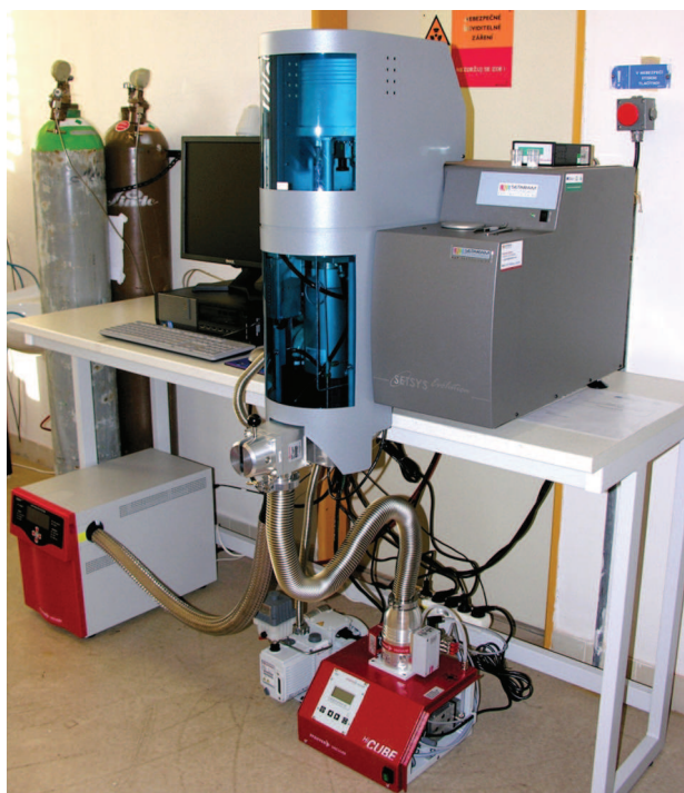
Termální analyzátor SETSYS TG-DTA/DSC 24 s hmotnostním spektrometrem / Thermal analyser SETSYS TG-DTA/DSC 24 with mass spectrometer
