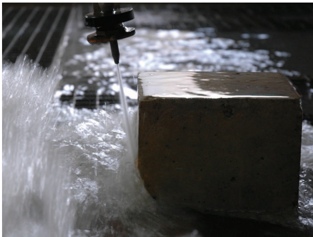
Zkouška odolnosti betonu proti erozi prováděná abrazivním vodním paprskem / Test of concrete resistance to erosion performed by abrasive water jet
