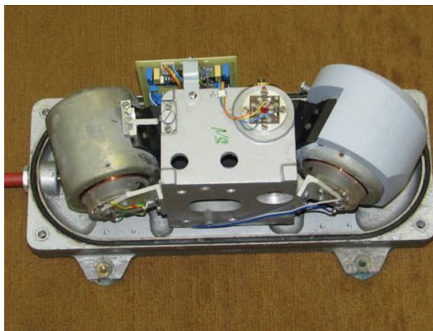
Ilustrační fotografie seizmometru S-5-S upraveného pro registraci rotační složky / The photo of S-5-S seismometer modified to the registration of rotating components
