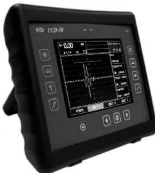
Obr. 16 Ultrazukový polní defektoskop UDC-50 pro měření in situ (NDK Kraft Praha)
