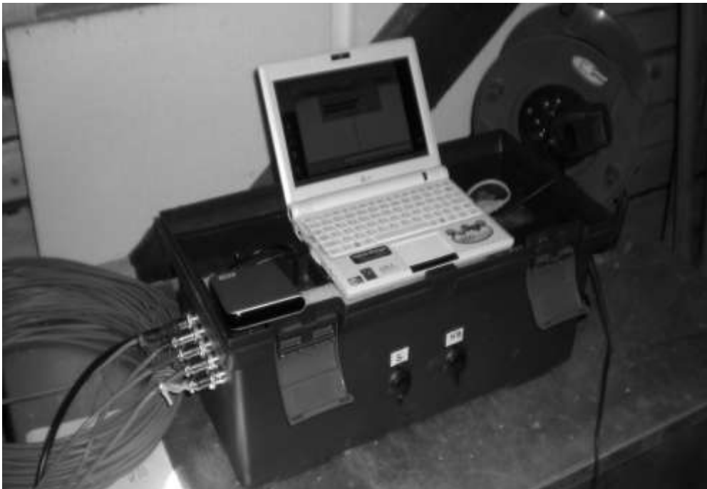
Obr. 14 Mikroseismická polní aparatura pro měření seismoakustických impulzů vzniklých napěťovým přetížením nebo zvýšením teploty
