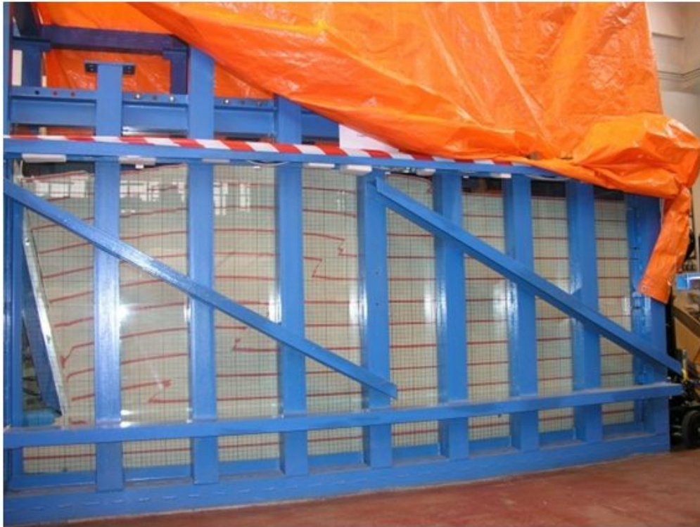
Konečný stav zrnitých těles po experimentech s tlakem v klidu a pasivním tlakem při otáčení stěny ( v = 1,0\text{m} ) kolem vrcholu (viz na levých stranách) - Experiment E5/0,2.
