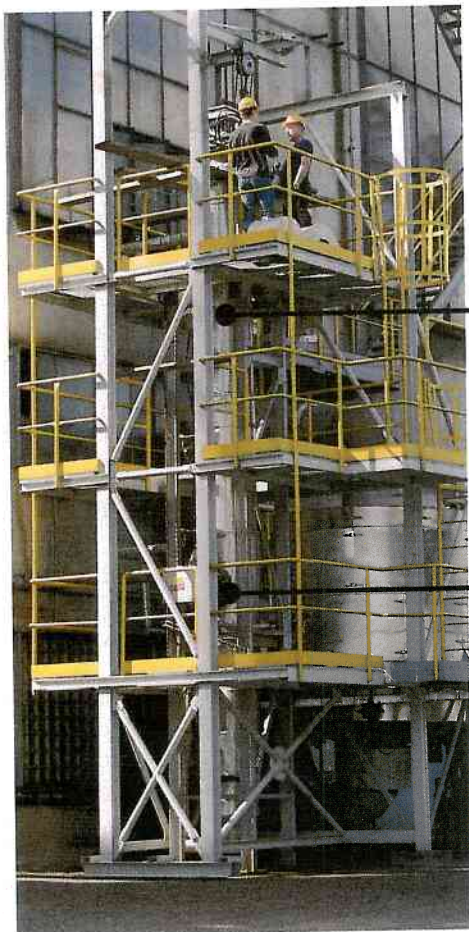
Testovací jednotka likvidace \text{N}_2\text{O} a \text{NO}_x v koncových plynech výroby kyseliny dusičné ÚFCH JH AV ČR
